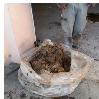
Amalgame de lingettes dans le réseau d'assainissement - Source : aveyronamont.fr
